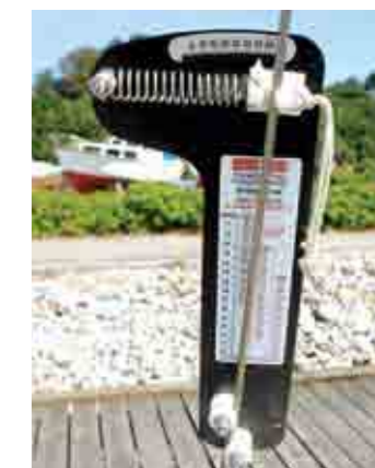
Man kan meget nemt spænde vantene i hver side lige hårdt, og sikre de er tottet hårdt nok med en rigspændingsmåler. Denne måler kan købes hos North Sails.
