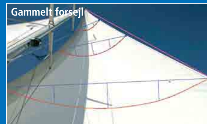
Gammelt forsejl Den gamle genua er tydeligt for dyb, og den største dybde ligger for langt tilbage i sejlet. Sejlet er også for rundt i agterliget.
