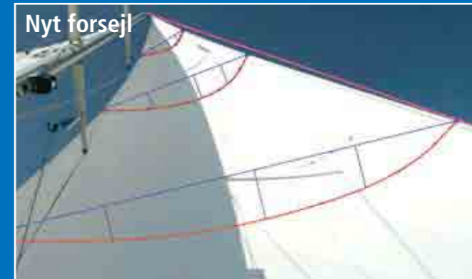
Nyt forsejl Den nye genua er tydeligt fladere, og faconen ligger længere fremme i sejlet med den ønskede flyvingeprofil.
